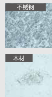
(图1) 测试结果/显微镜照片 不锈钢表面有些许霉菌孢子（黑点）生长，但仅止于表面而未渗入内部。（2019年6月Cleanup观察）
